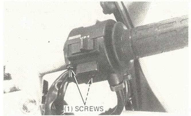
Porre la pompa del freno anteriore sul manubrio e montare il supporto con il segno "up" rivolto verso l'alto. Allineare il margine del supporto con il segno di riferimento sul manubrio. Stringere prima il bullone superiore e poi quello inferiore. Collegare i fili dell'interruttore dello stop all'interruttore.
