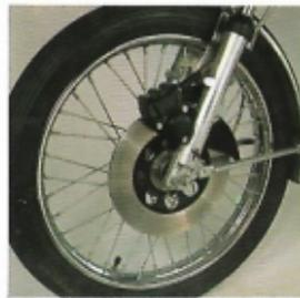
Il freno a disco anteriore a comando meccanico è una garanzia di sicurezza a tutte le velocità e su ogni tipo di fondo.
