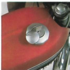
Il tappo del serbatoio del carburante è dotato di serratura a chiave, una raffinatezza riservata finora a moto di classe superiore.
