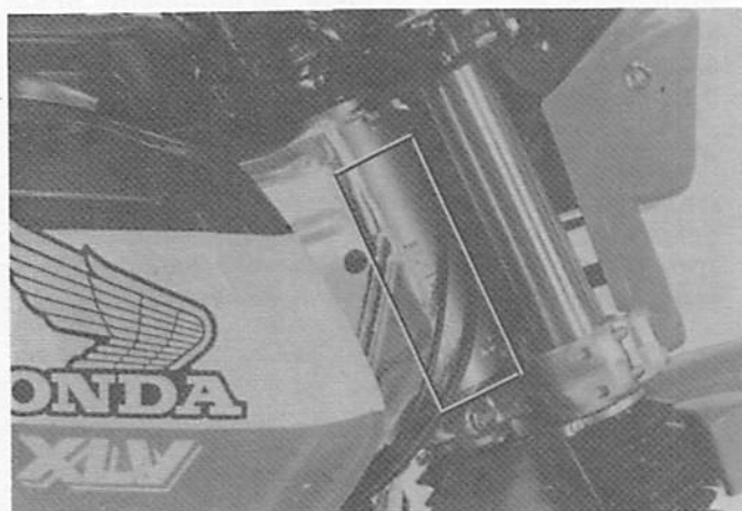
(1) Il numero di serie del telaio è stampigliato sul lato destro della testa dello sterzo.
