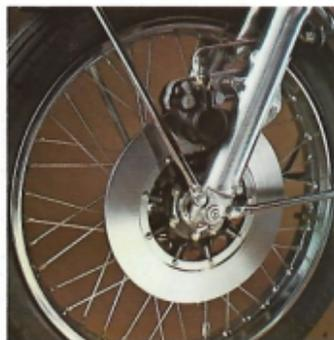
Il freno a disco e comando idraulico, potente e perfettamente modulabile, è una garanzia di sicurezza a tutte le velocità e sui più svariati tipi di fondo.
