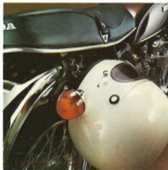
Due pratici ganci permettono di assicurare una coppia di caschi alla moto, bloccandoli con la sella dotata di serratura a chiave. Ancora una dimostrazione della cura posta dalla Honda nel costruire moto adatte a tutte le esigenze.
