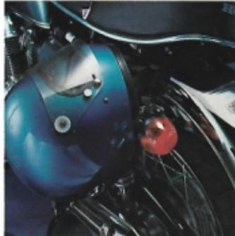
Due appositi ganci permettono di assicurare una coppia di caschi alla moto, bloccandoli con la sella dotata di un'apposita serratura a chiave. Ancora una dimostrazione della cura posta dalla Honda nel costruire moto adatte a tutte le esigenze.
