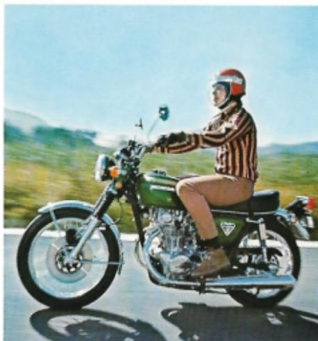
La CB 450 possiede le caratteristiche di una supermoto. Motore bicilindrico a carburatori indipendenti, doppio albero a cammes, freno anteriore a disco, avviamento elettrico con cambio a 5 velocità a rapporto avvicinato. Il telaio a culla sdoppiata offre robustezza ed elasticità. Il sistema di lubrificazione, considerato il cuore di un veicolo, incorpora due filtri olio, uno a membrana ed uno centrifugo.
