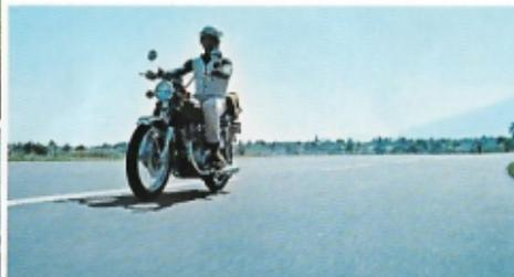
**CARATTERISTICHE** ● tipo: due cilindri paralleli verticali ● raffreddamento ad aria ● 4 tempi ● cilindrata: 444 cc ● potenza: 45 HP a 9000 g/m ● alesaggio x corsa: 70 x 57,8 ● rapporto di compressione: 9:1 ● avviamento: elettrico e a pedale ● frizione: a 7 dischi a bagno d'olio ● dimensioni - L x W x H - 2100 x 800 x 1140 mm ● passo: 1380 mm ● peso: 180 kg.
