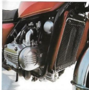
Il quattro cilindri boxer raffreddato ad acqua ha permesso di ottenere una notevole potenza pur mantenendo degli ottimi valori di coppia che consentono una guida fluida e rilassata anche alle basse velocità.
