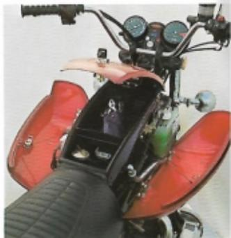
Il "falso" serbatoio si apre in tre parti e rivela l'alloggiamento dell'impianto elettrico e degli accessori. Resta comunque a disposizione un notevole spazio per libretto, ferri, ed altri piccoli oggetti.
